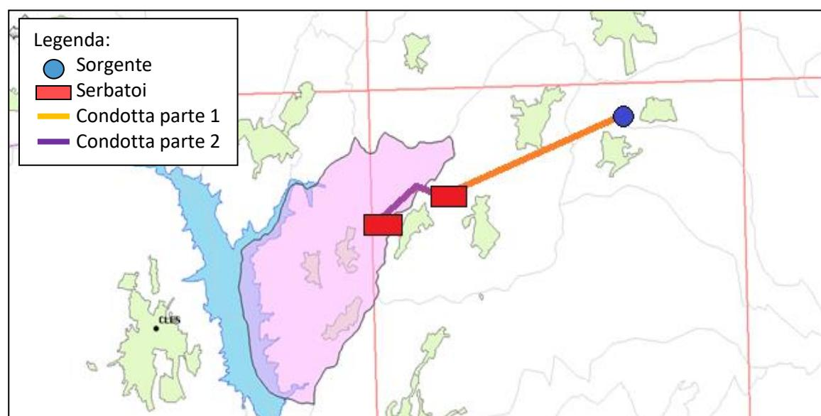
**Figura 10 Localizzazione della condotta di adduzione del Comune di Sanzeno su cartografia a scala maggiore**
